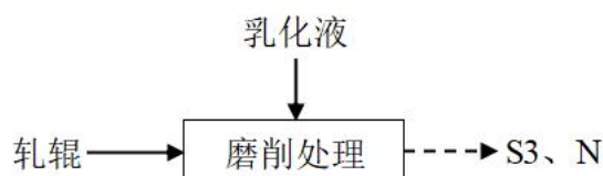
图 2-5 磨削处理工艺流程图及产污环节图
